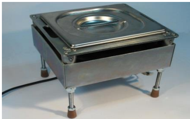
Прибор АСБ-1 для автоматизированного определения остаточных напряжений
