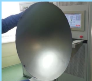
Антенный параболический отражатель из композиционного материала с ионно- плазменным наноструктурным металлическим покрытием
