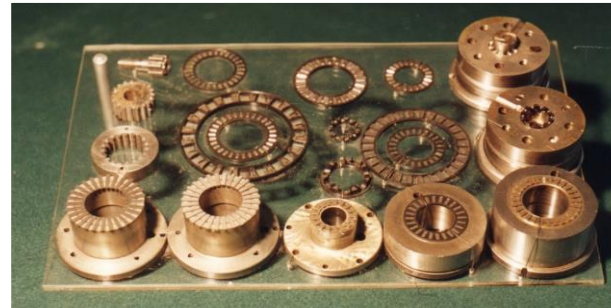
Высокоточные формующие детали литьевых форм для получения пластмассовых сепараторов
