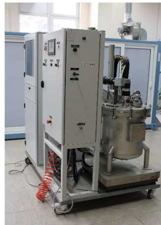
Станция для изготовления композитных изделий методом вакуумной инфузии и RTM
