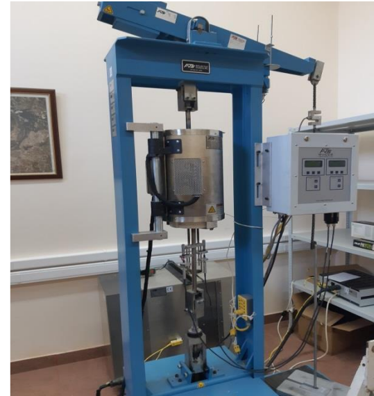
Испытательная машина на ползучесть при нормальной и повышенной температурах WinCCS
