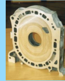
Крышка РПД с износостойкими покрытиями HA67 и (TiC)Ni
