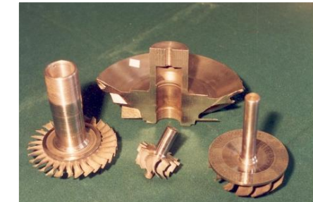
Ротор турбин ГТД и турбокомпрессоров (никелевые сплавы + стали, керамика+стали)
