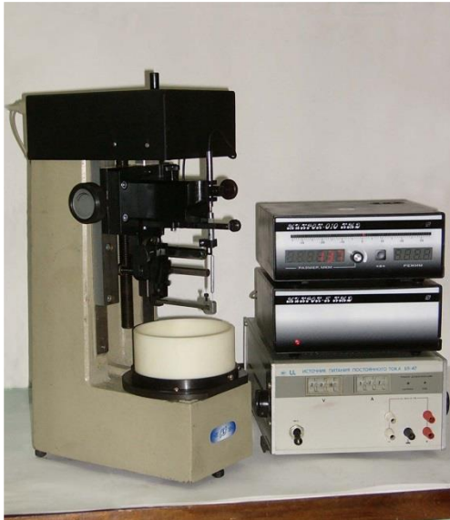
Прибор АСБ-1 для автоматизированного определения остаточных напряжений
