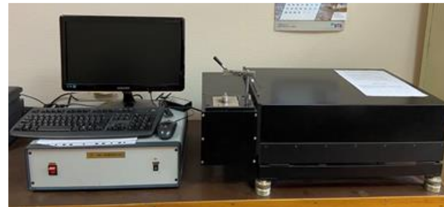
Спектрометр эмиссионный МСА-I с источником возбуждения спектра КОМПАКТ-Н-1
