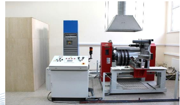
Комплекс для изготовления однонаправленных препрегов
